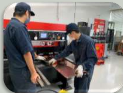
シャーによる切断加工
